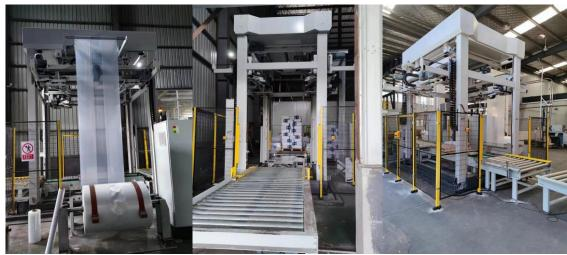
COLD SHRINK PACKING MACHINE IS SUITABLE FOR THE GOODS STACKED ON THE PALLET TO CARRY ON THE BACK CHANNEL TRANSPORTATION PACKAGING, STORAGE PACKAGING.
